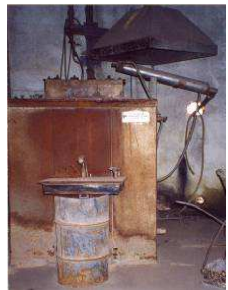
Secadora de concentrado y extracción de mercurio por evaporación
