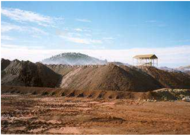
Riego por aspersión de pilas de mineral con Cianuro Sódico
